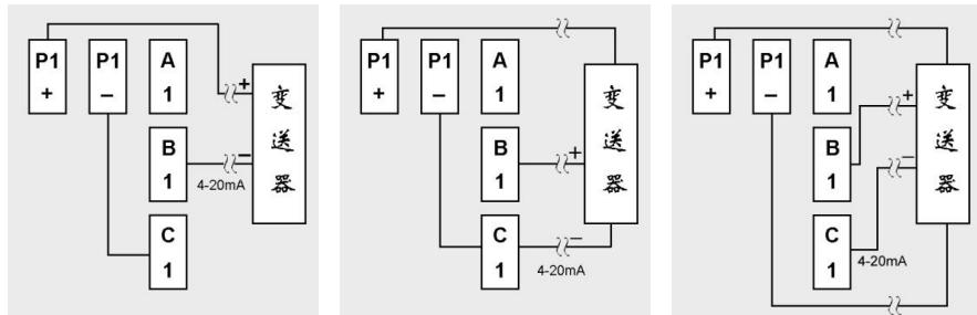
两线制变送器接线图
