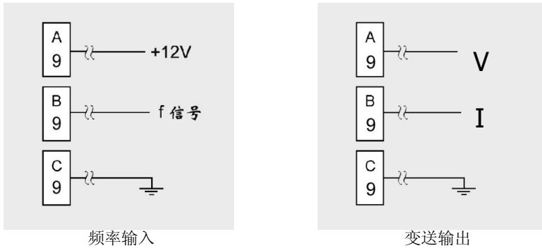
图 2-2-5 频率输入、变送输出接线图
