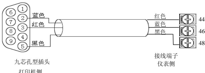
图 2-2-6-B 打印机与仪表间的 RS-232C 通讯线
