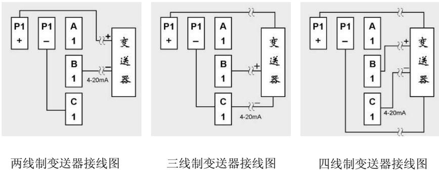
图 2-2-5 带馈电变送器接线图
