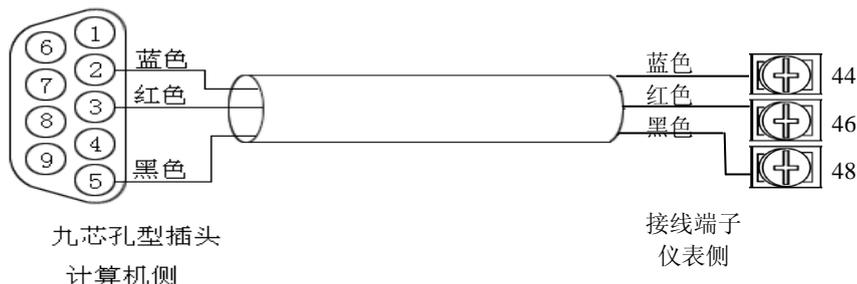
图 2-2-6-A 计算机与仪表间的 RS-232C 通讯线
