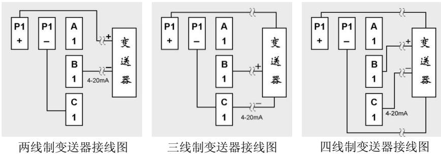
图 2-2-5 带馈电变送器接线图
