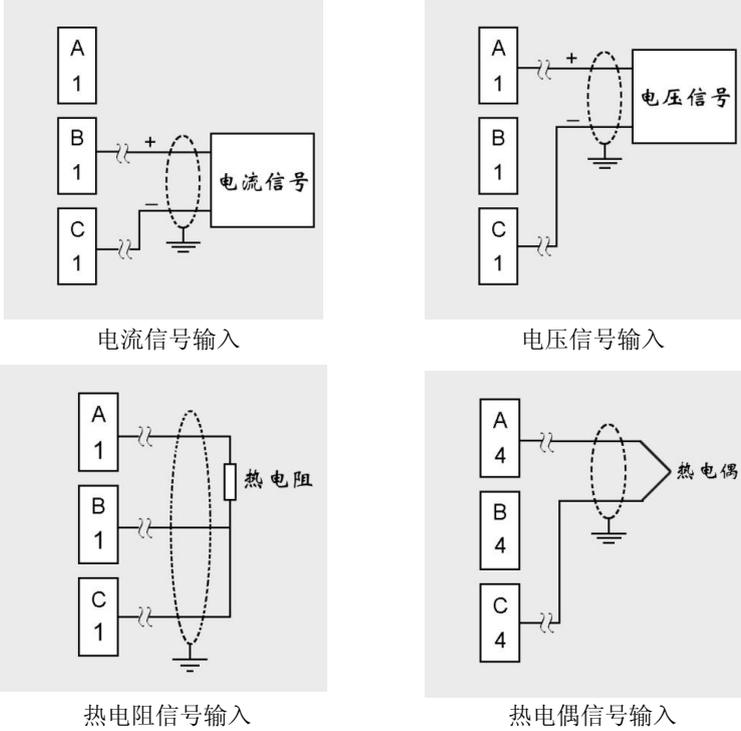
图 2-2-4 模拟量输入信号接线图
