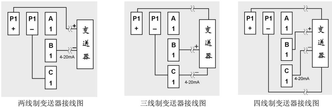
图 2-2-6 带馈电变送器接线图
