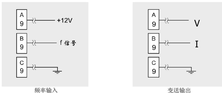
图 2-2-5 频率输入、变送输出接线图
