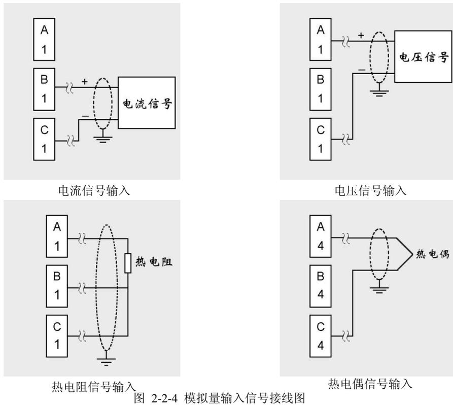
图 2-2-4 模拟量输入信号接线图
