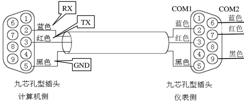
图 2-2-7-A 计算机与仪表间的 RS-232C 通讯线
