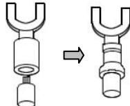
用绝缘套筒压接线端子（4mm 螺钉用）
