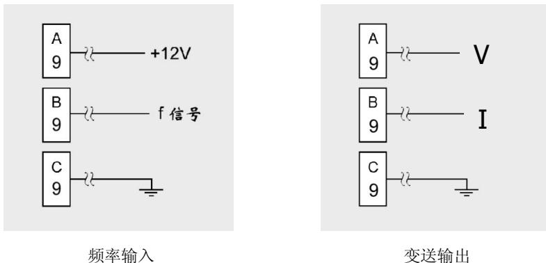
图 2-2-5 频率输入、变送输出接线图
