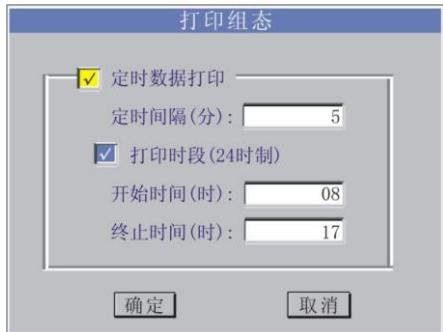
若勾选“定时数据打印”则系统每隔设定的时间就打印一次各通道的即时数据，会一直进行下去。用户也可以设置定时打印的时段（按 24 小时制），即只在此时段中进行定时打印，超出此时段就不再打印了。
