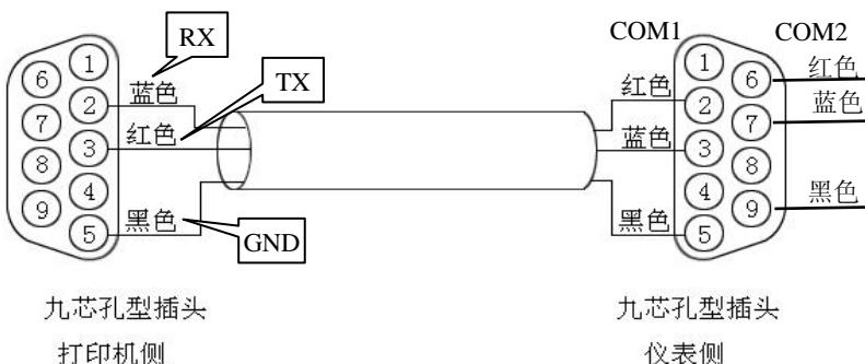
图 2-2-7-B 打印机与仪表间的 RS-232C 通讯线
