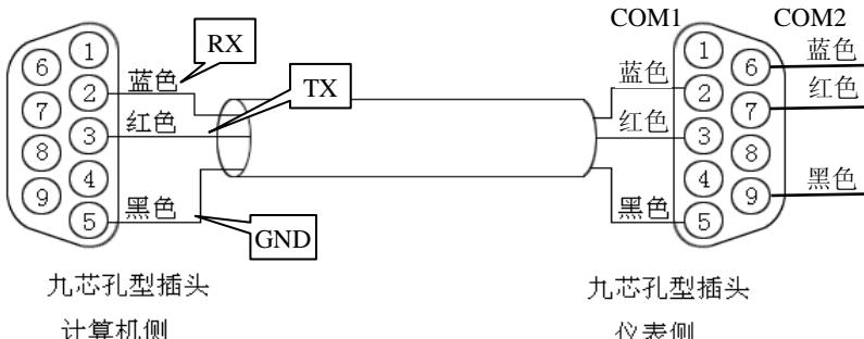
图 2-2-7-A 计算机与仪表间的 RS-232C 通讯线
