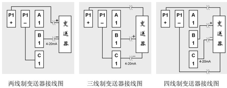
图 2-2-6 带馈电变送器接线图
