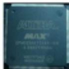
采用CPLD代替传统的分立组件电路，使电路板功耗低、抗干扰能力强可靠性提高。同时设计了高速图形处理优化算法。
